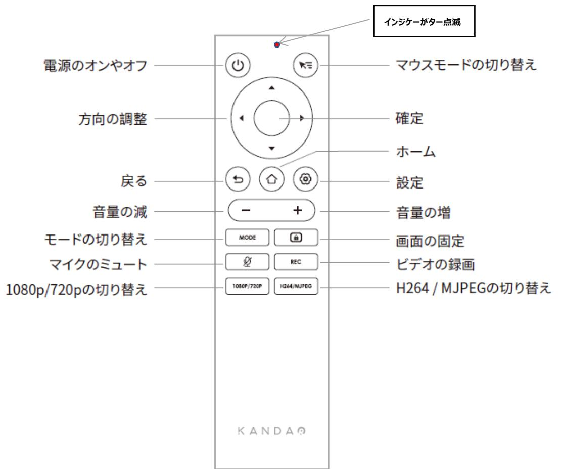
b. Kandao Meeting Pro は、自動的にリモコンに接続されます。接続すると、リモコンのインジケーターライトが消え、ディスプレイインターフェイスに「コントローラーが接続されました」というプロンプトが表示されます。
