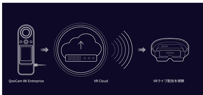
カメラ本体に有線LANポートが搭載されており、カメラを5Gネットワークに簡単に接続できます。QooCam 8K Enterpriseカメラによる撮影、撮影した映像をリアルタイムにカメラ内部で8k映像にステッチングされ(高価なステッチングサーバーが必要ではない)、8K360°ライブ配信をPCを使用せずに効率的に行えます。
